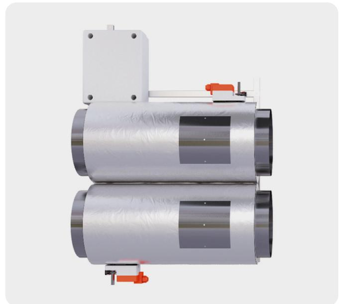
Als Teil eines Komplettsystems dienen die SMART Boxen als Übergabemodule der unabhängigen Regelung von Zu- und Abluft im Mehrgeschossbau. Die SMART Box besteht aus zwei eigenständigen Rohren inklusive Mess- und Regeleinrichtung und einer Steuerungs-box, die mithilfe eines Tragrahmens miteinander verbunden werden können. Der Zu- und Abluftvolumenstrom kann unabhängig voneinander eingestellt werden. Jedes Rohr verfügt zusätzlich über einen Zugang zu den beweglichen Bauelementen.
