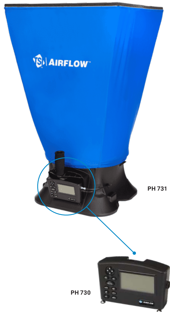
Abnehmbares Mikromanometer PH 730: leichtes Arbeiten auch an unübersichtlichen Bereichen
