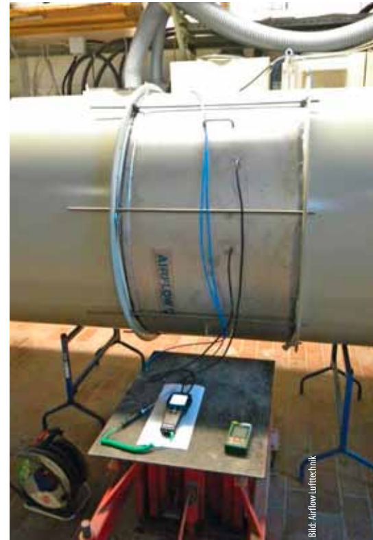
5 Vor ihrem Einsatz wurde die Messeinrichtung von Airflow im eigenen Labor kalibriert. Airflow gehört zu den wenigen Unternehmen in Deutschland mit einer Akkreditierung des Deutschen Kalibrierdienstes (DKD) für Strömung von Gasen.
