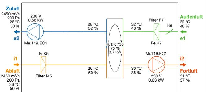
Schematische Darstellung der Funktionen des Geräts. Die Positionen der Ein- und Ausgänge muss mit der späteren Ausführungsart nicht voll übereinstimmen.
