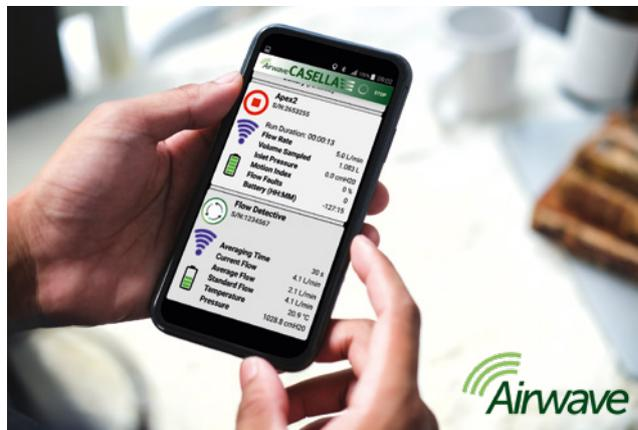
Verwenden Sie einfach die kostenlose Airwave App auf Ihrem mobilen Gerät zum drahtlosen Empfang und Versand per E-Mail von Kalibrierdaten. Die Kalibrierung einer Apex2 Pumpe ist in einem geschlossenen Regelkreis möglich, so dass keine manuellen Einstellungen der Pumpe erforderlich sind. Dies halbiert die Kalibrierdauer für Apex2 Luftprobenahmepumpen.
