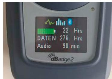
Mithilfe des OLED-Displays kann das dBadge2® die Daten des D1, D2 und D3 farblich kennzeichnen, um so die Überprüfung vor Ort zu vereinfachen, und
