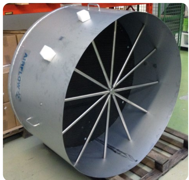
Die Experten der Airflow Lufttechnik GmbH entwickelten und bauten ein individuelles Messgerät für die Fraport AG – bestehend aus Staugitter, Wabengleichrichter, Prallplatte und Messgerät.
