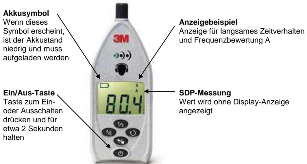
Abbildung 1-2: Eingeschaltet mit angezeigtem SPD-Display
