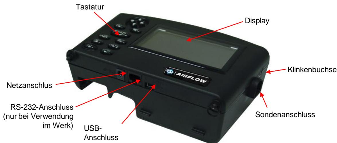
**Abbildung 1: Merkmale des Mikromanometers PH730/PH731, Vorderansicht**
