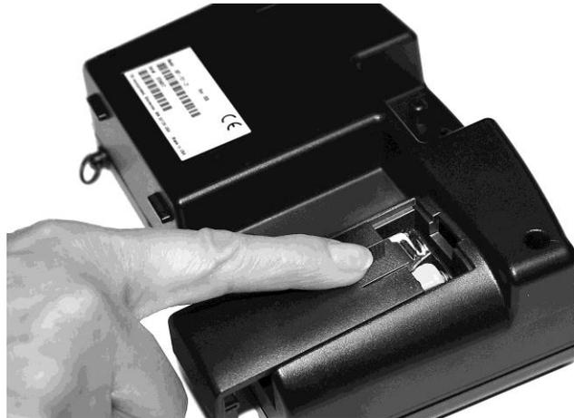
**Abbildung 5: Abnehmen der Batteriefachabdeckung**
