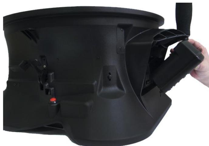
**Abbildung 10: Befestigung des Messgeräts am Sockel der Messhaube**
