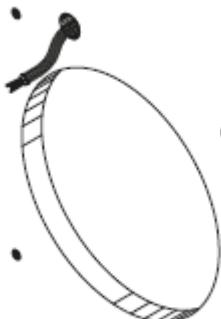
Der Lüfter wird über das Abluftrohr montiert. Stellen Sie sicher, dass das Kabel durch die mitgelieferte Kabeltülle geführt wird. Richten Sie den Ausrichtungspfeil vertikal aus. Mit den 4 mitgelieferten Schrauben befestigen Sie das Gerät an der Wand oder Decke.
