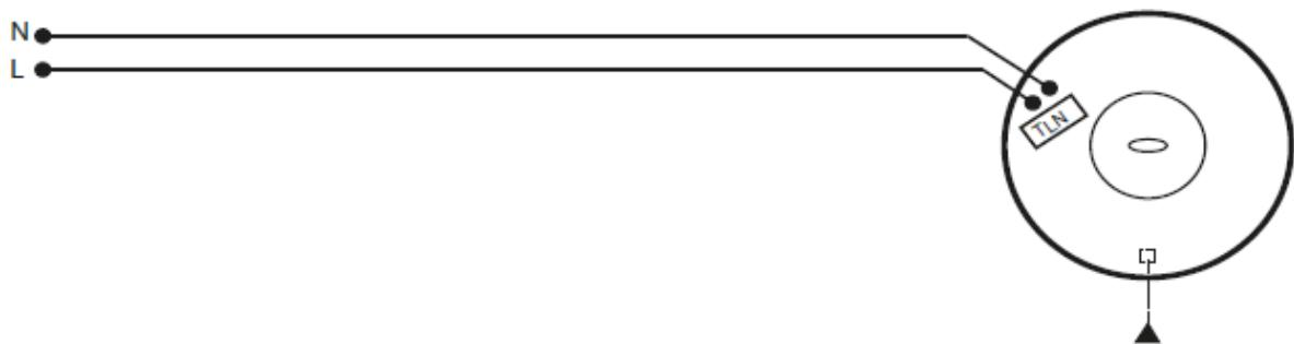
Alle elektrischen Installationen sollten von einem zugelassenen Elektroinstallateur gemäß VDE 0100 erfolgen. iCONSTANT-Lüfter erfordern eine 90-264V 50/60Hz-Spannungsversorgung. Diese sind schutzisoliert, so dass keine Erdung erforderlich ist und sind in Schutzzone 2 und 3 zu installieren. In Schutzzone 1 montierte Lüfter müssen über eine Schutzkleinspannungs-Klasse verfügen. Das iCONSTANT-Sortiment entspricht Schutzklasse IPX5 (strahlwassergeschützt).
