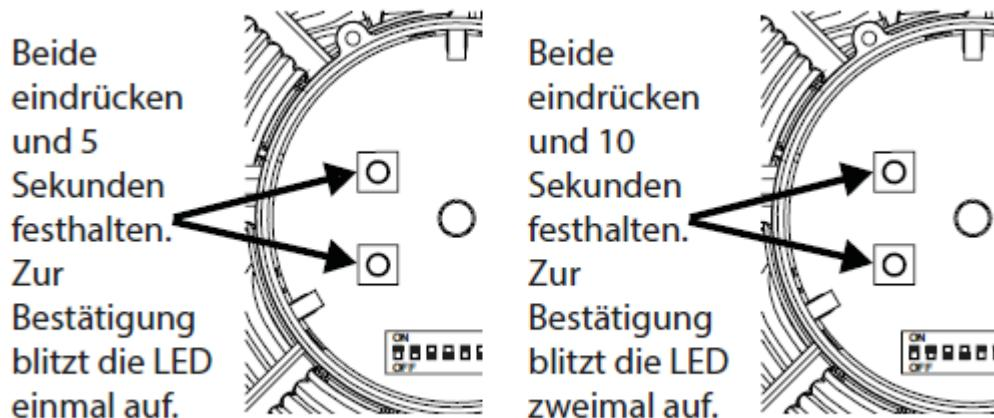
Setzen Sie die Elektronikabdeckung ein und befestigen Sie diese mit den 2 Fixierungsschrauben. Prüfen Sie, ob der Lüfter läuft. Sollte die LED permanent aufleuchten, prüfen Sie, ob das Lüfterrads blockiert ist, und beheben Sie dies entsprechend. Setzen Sie die Frontblende wieder auf und drehen Sie diese im Uhrzeigersinn fest.
