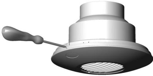
Entfernen Sie die Halteschraube an der unteren Kante mit einem Schraubenzieher
