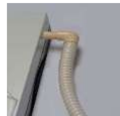
Bei öffnen des Deckels, Trennung des Kondensatablaufs vom Gerät vornehmen
