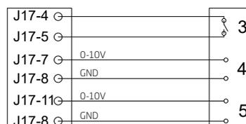
Das A-BMS legt das 13,5 VDC-Ausgangssignal über einen Schließerkontakt (NO) (3) von Klemme J17-4 an Klemme J17-5 (AI#1). Dadurch startet und stoppt das Lüftungsgerät gem. Programmierung des A-BMS.
