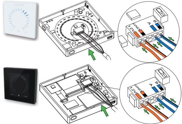
Das Bedienpaneel liegt normaler Weise bei der Lieferung lose bei, ein 6,5 m langes Datenkabel ist vormontiert. Das Bedienpaneel ist in geeigneter Höhe an der Wand zu montieren, generell im gleichen Raum wie das Lüftungsgerät, es ist aber auch eine Montage in angrenzenden Räumen möglich.
