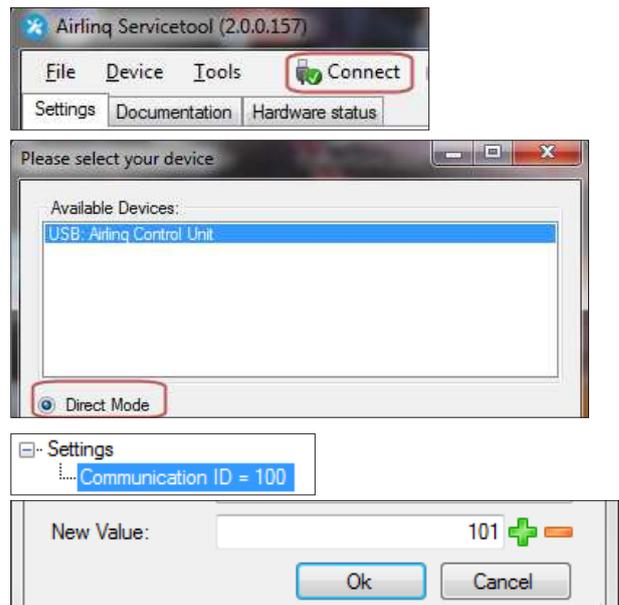
Paarung Lüftungsgerät mit Kühlmodul:
