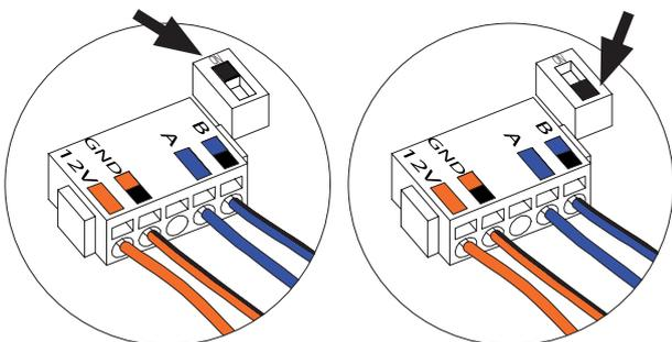
Die Jumper einer Steuerbox sind ab Werk offen („OFF“).
