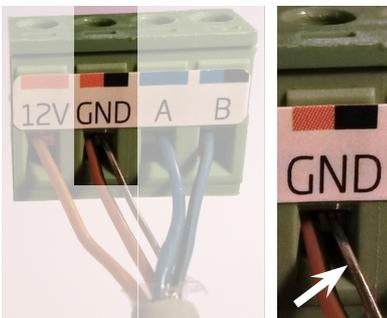
Die Abschirmung für das Bedienpaneel und alle Sensoren ist wie folgt bei der Steuerbox im Lüftungsgerät anzuschließen:
