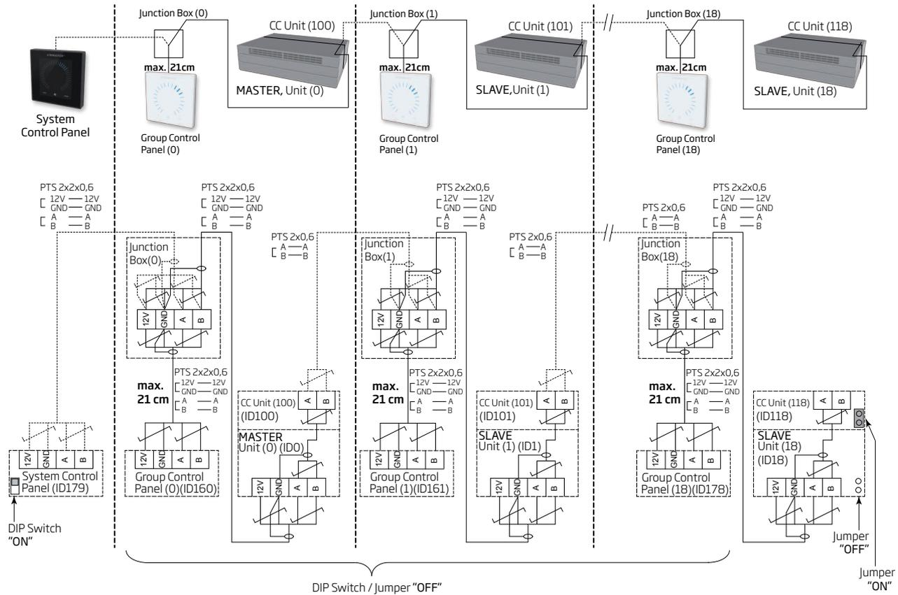
Die Verteilerdose (Junction Box) muss in unmittelbarer Nähe des Bedienpanels montiert sein. Eine größere Kabellänge als 21 cm ist nicht zulässig und kann zu Kommunikationsfehlern führen.
