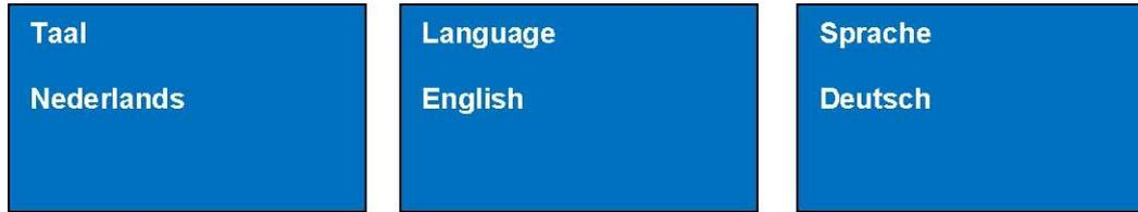
Der Bildschirm wird in einer anderen Sprache angezeigt, wenn die Auswahltaste gedreht wird. Sie können die Auswahl bestätigen, indem Sie die Auswahltaste drücken.
