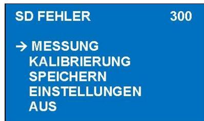
Wenn der DIFF beschädigte Daten enthält (verursacht durch das verfrühte Entfernen der SD-Karte) zeigt es die Warnmeldung „beschädigte Daten“ an. Die Warnung verschwindet, wenn Sie die Auswahl Taste drehen. Die Räume, deren Daten nicht beschädigt sind, können trotzdem vermessen werden.
