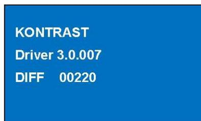
Der Bildschirm informiert über die Seriennummer und Treibernummer des DIFFs. Helligkeit oder Kontrast können durch das Drehen der Auswahltaste angepasst werden. Die Einstellung wird anschließend durch das Drücken der Auswahltaste bestätigt.
