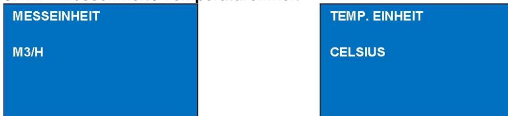
Die Messeinheit kann durch Drehen der Auswahltaste ausgewählt werden. Die Einstellung wird anschließend durch das Drücken der Auswahltaste bestätigt. Die folgenden Messeinheiten können ausgewählt werden:
