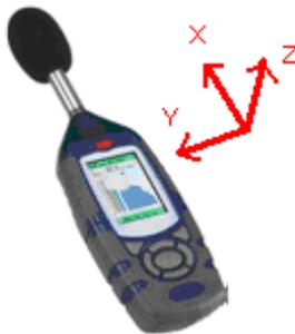
X liegt in der Richtung zum Mikrofon, Z liegt in der Richtung der Anzeige und Y liegt in der Richtung seitlich vom Gehäuse.
