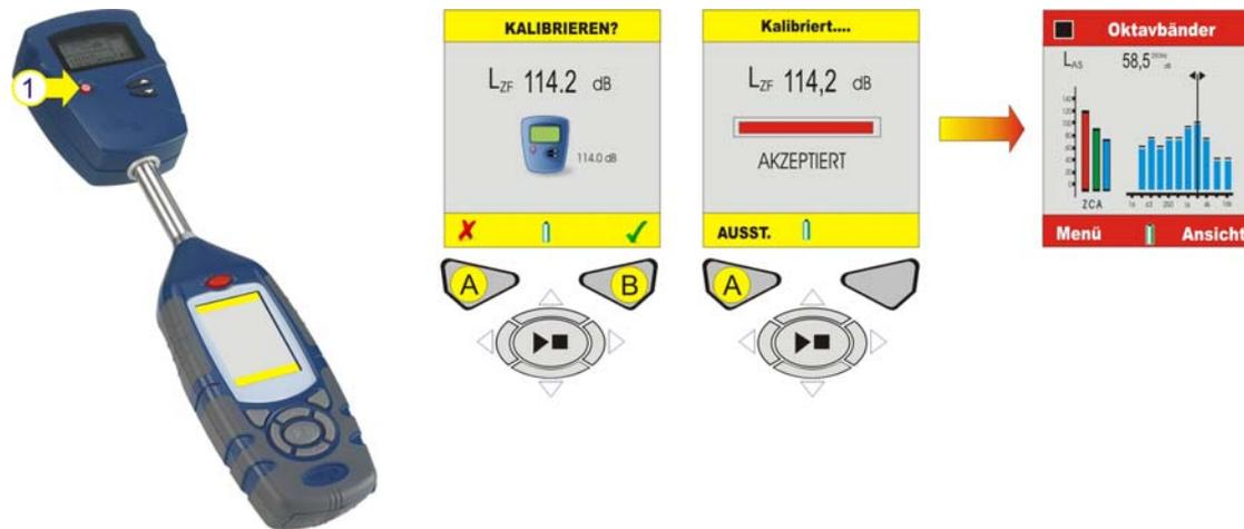
Abbildung 15 Instrumentenkalibrierung
