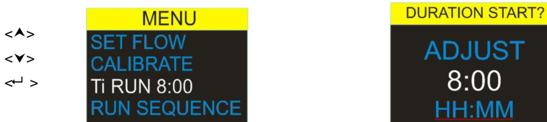
Der **Laufdauer-Timer** gestattet der Pumpe, Entnahmen für eine voreingestellte Periode vorzunehmen und automatisch abzuschalten, wenn die Periode beendet ist. (Plus- & Pro-Modelle)
