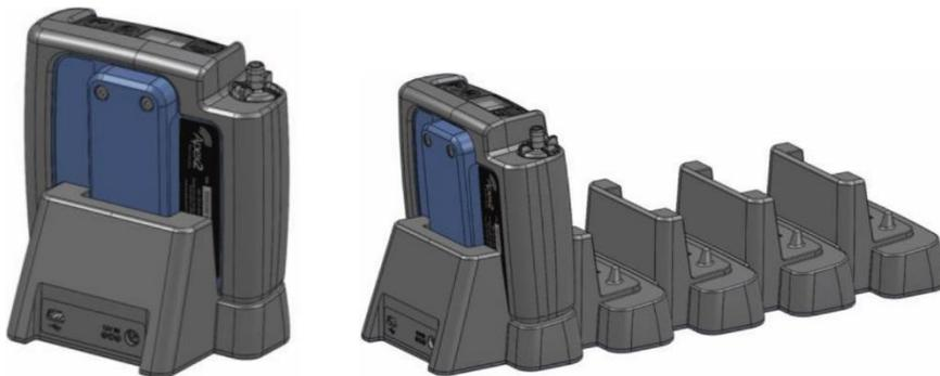
Ein Einfach-Ladegerät wird mit einer PC18 Universal-Stromversorgung (2,1mm Steckverbinder) gespeist und die 5-fach-Version benutzt einen PC28 Adapter (2,5mm Steckverbinder). Eine rote LED leuchtet auf dem Ladegerät auf, um anzuzeigen, dass der Strom angeschlossen ist.
