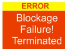
Blockierung Neuversuch: Wenn die Pumpe die Soll-Durchflussrate innerhalb von 5 % nicht länger als 20 Sekunden beibehalten kann (z.B. dein geknickter Schlauch oder eine Einlassblockierung), hält sie automatisch an. Nach einer Minute versucht die Pumpe, neu zu starten. Ist die eingegebene Anzahl neuer Versuche nicht erfolgreich, beendet die Pumpe den aktuellen Probenahmeauf.
