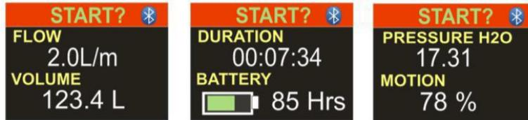
Kippen Sie die Pumpe nach vorn oder nach hinten, um den Sichtwinkel der Anzeige automatisch zu wechseln. Dies bedeutet, dass Sie die Anzeige von vorne ansehen können, während die Pumpe benutzt und vom Benutzer getragen wird, oder von hinten, wenn Sie sie selber tragen.
