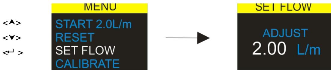
Wählen Sie diese Option, um die Durchflussrate zu ändern. Ändern Sie die Durchflussrate mithilfe der Pfeiltasten und drücken Sie die Eingabetaste zur Bestätigung.
