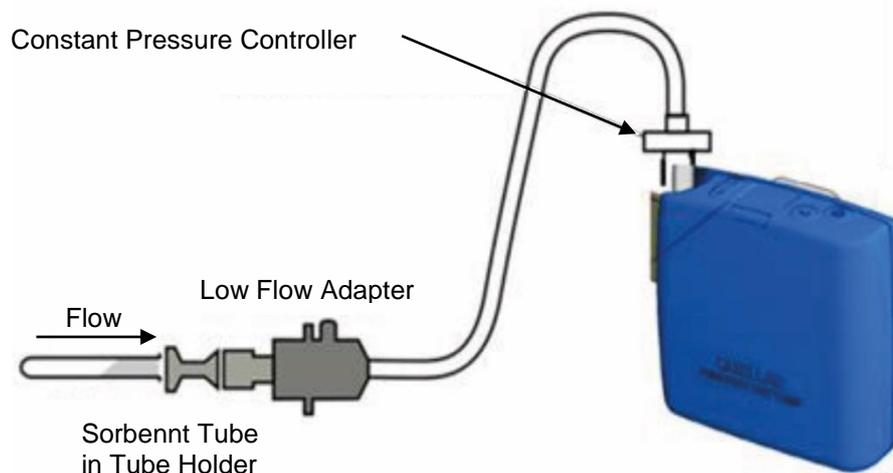
Dies ermöglicht es, das Instrument mit einem Adsorptionsröhrchen bei niedrigen Durchflussraten bis zu 5 Milliliter/Min zu benutzen.
