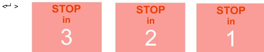
Um einen Probenahmelauf zu stoppen oder zu pausieren, drücken und halten Sie die Eingabetaste <↵>, um die Countdown-Anzeigen zu erhalten. Um den STOPP-Betrieb zu verlassen, geben Sie die Eingabetaste <↵> zu beliebigem Zeitpunkt während des Countdowns wieder frei. Die Dashboard-Displayanzeigen erscheinen.
