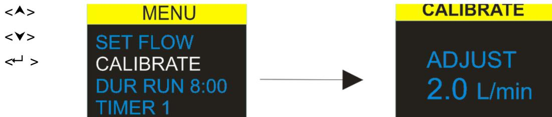
Um eine Einpunktkalibrierung vorzunehmen, befestigen Sie einen Probenahmekopf, Durchflussschlauch oder andere Durchflussmessgeräte zur Ansaugdüse der Pumpe, dann wählen Sie diese Option zum Kalibrieren
