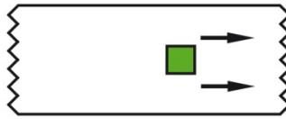
Fühler in der Mitte des Kanals montieren.
