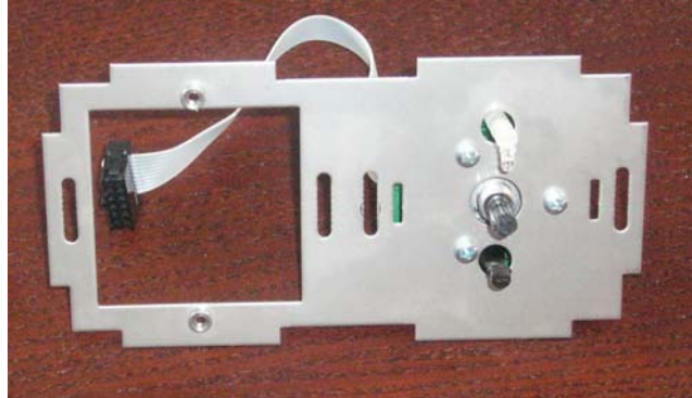
Bild 12 Innenansicht der Steuereinheit
