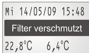
Bild. 7 Meldung der Filterverschmutzung
