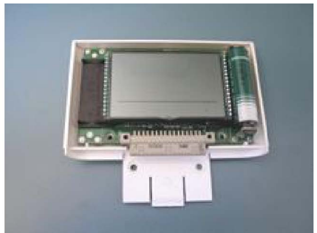
Bild: Öffnen des HUMLOG 10 Bild: Wechseln der Batterie für Batteriewechsel
