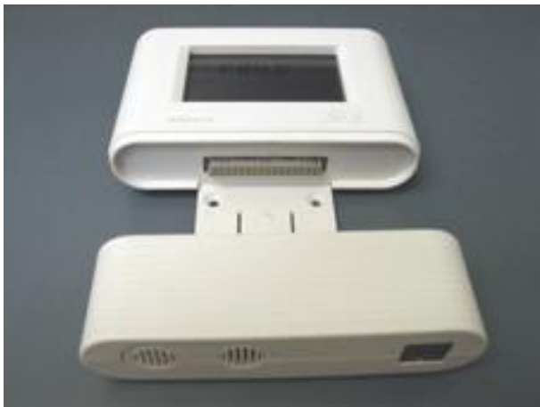
Bild: Zusammenbau der Module
