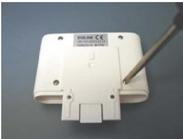
Bild: Öffnen des HUMLOG 10 Bild: Wechseln der Batterie für Batteriewechsel
